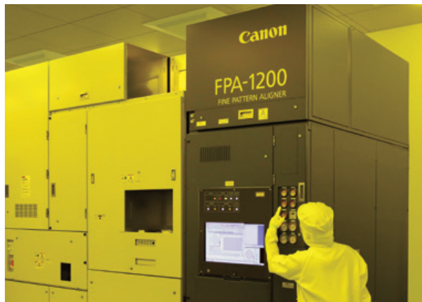
製造コストを大幅に抑えるナノインプリント半導体製造装置
