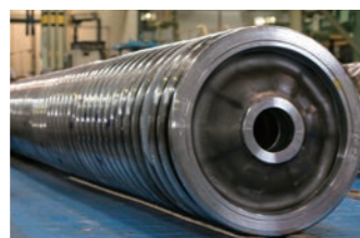
鉄道向け軽量化・高速化による省エネルギー 鉄道用車輪
