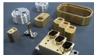
飲料用アルミ蓋製造ラインで使用する精密金型
