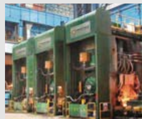
連続鋳造・熱間圧延連結設備 ARVEDI ESPライン
