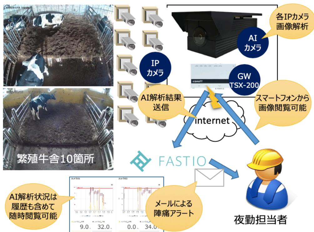
本システムの技術的特徴として、10台の汎用ネットワークカメラから送られる映像を一台のエッジAIカメラで並列に処理するアーキテクチャを採用しており、すでに稼働している複数のネットワーク監視カメラをアドオンでAI化するレトロフィットソリューションとしての展開が可能な点が挙げられます。
